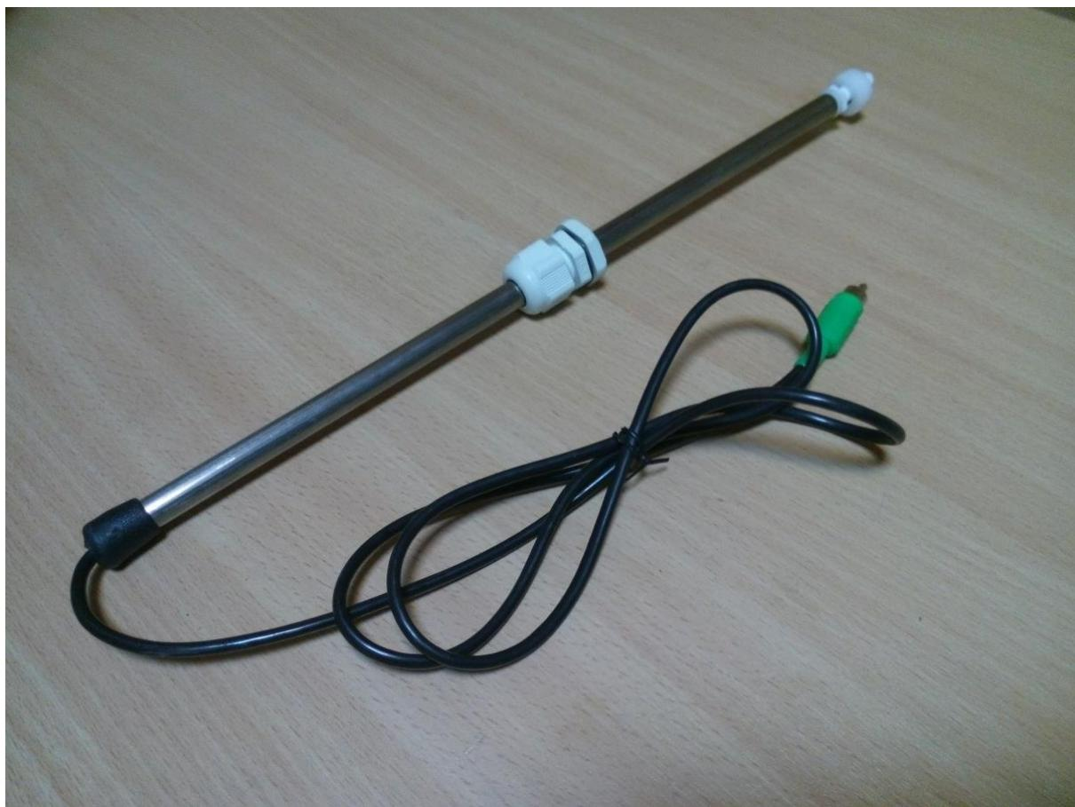
Датчик объема спирта состоит из нержавеющей трубы диаметром 10мм, регулятором подъема, электронным поплавком и соединительным кабелем с разъемом.
