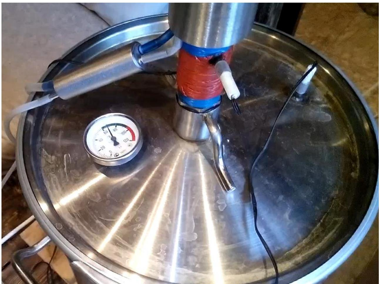
Фото. Датчик в кубе и дистилляторе
