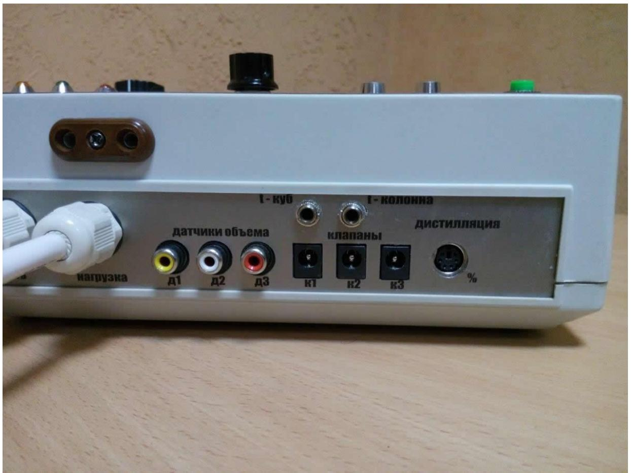
Фото 2. Внешний вид блока с разъемами подключения датчиков
